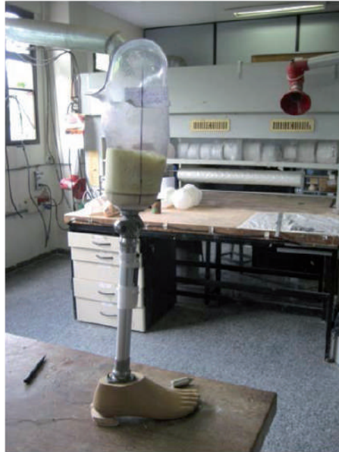
Figura 34 – Montagem dos componentes modulares
