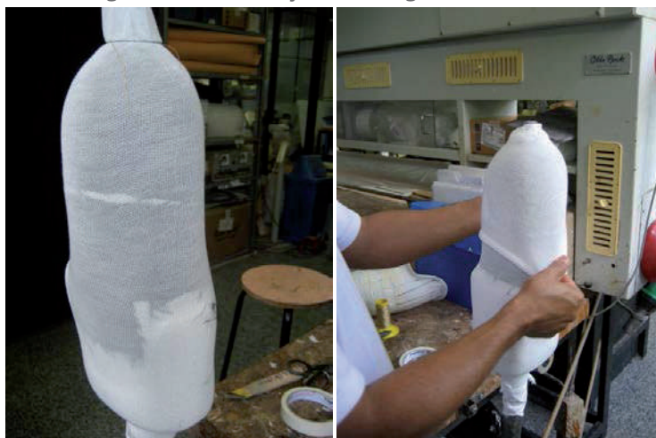
Figura 19 – Laminação (montagem das malhas)
