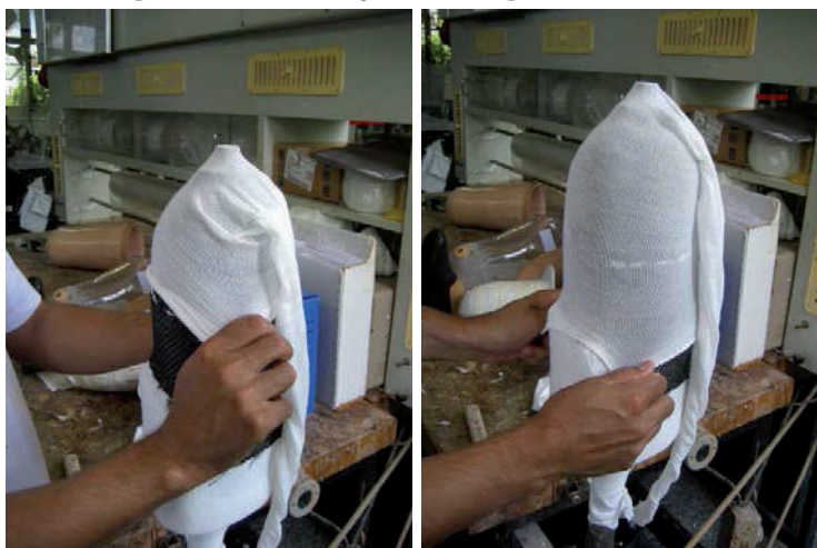
Figura 18 – Laminação (montagem das malhas)
